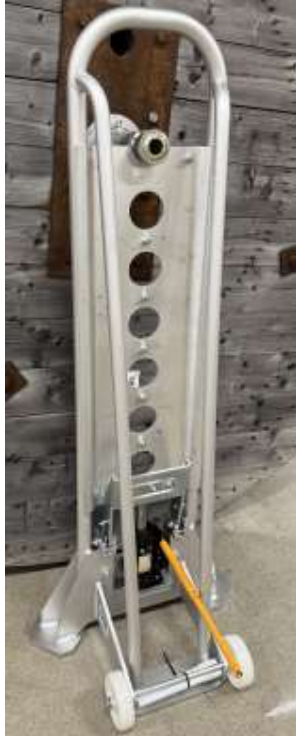
7 Kabeltrumma i lyft läge
