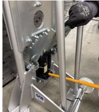
8 Vid frisläppning av trumman – pumpa upp trumman för att lösgöra spärren och sänk därefter domkraften
