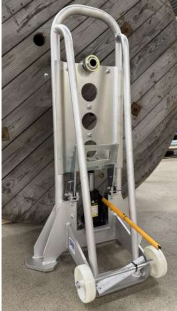
7 Kabeltrumma i lyft läge
